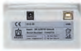
Задняя часть (панель) с сетевым адаптером и USB портом
