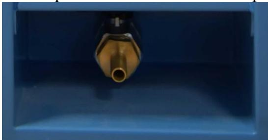
Рис.14 - Шаровый кран для слива воды из камеры
