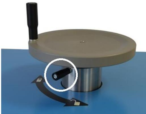
Рис.9 - Ручка блокировки замка крышки (Ручка 1)
