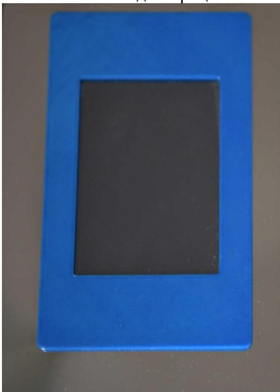
Рис.6 - Сенсорная операторская панель управления.
