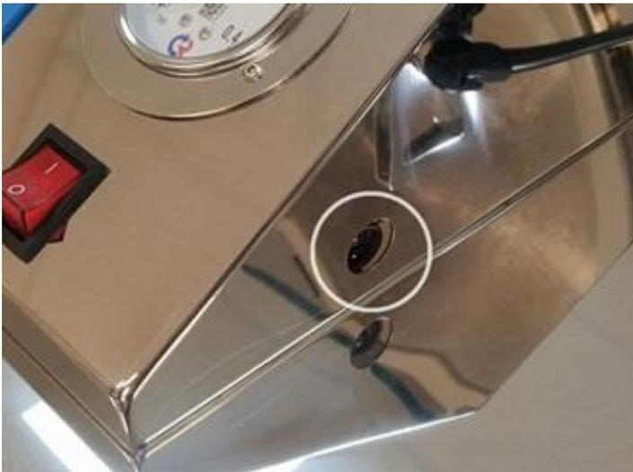
Рис.6 Датчик контроля закрытия двери и блокировки замка
