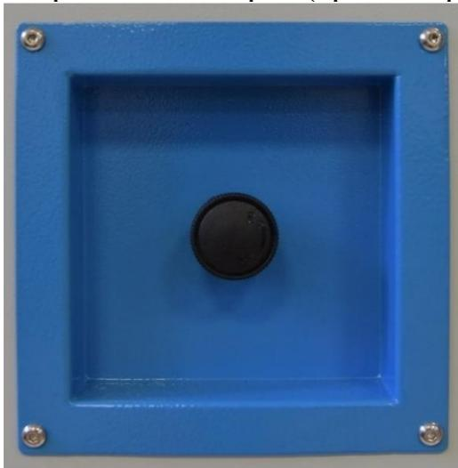
Рис.8 - Кран ручного сброса пара
