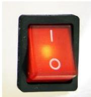
Рис.5 - Кнопка включения/выключения
