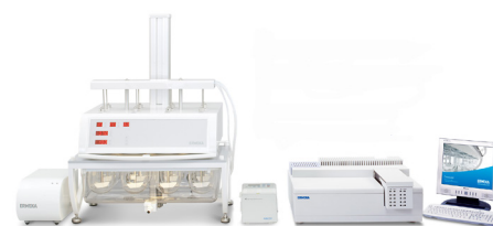
Online-система растворения со спектрофотометром
